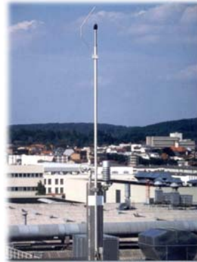
Bild 1 Wetterfeste Mikrofoneinheit über den Dächern des Industriebetriebes und Geräteschrank
