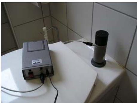
Abbildung 3: Kleinhammerwerk zur Körperschallanregung auf einem WC-Becken
