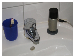
Abbildung 3: Kleinhammerwerk zur Körperschallanregung auf einem Waschbecken
